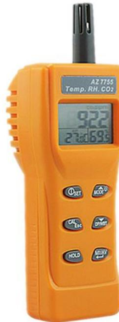
Das CO<sub>2</sub>-Messgerät wird zur Messung des CO<sub>2</sub>-Gehalts in der Luft sowie der Messung von Temperatur und Feuchte verwendet. Es hat einen CO<sub>2</sub>-Messbereich von 0 - 9999 ppm (parts per million). Die Referenz liegt bei 1000 ppm in einem geschlossenen Raum. Die Messgenauigkeit beträgt  $\pm 50$  ppm oder  $\pm 5$  % vom Messwert.
