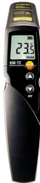
Das Infrarot Thermometer wird zur berührungslosen Temperaturmessung verwendet. Es hat einen Messbereich von -30 °C bis +400 °C. Die Messgenauigkeit beträgt  $\pm 1,5$  °C.
