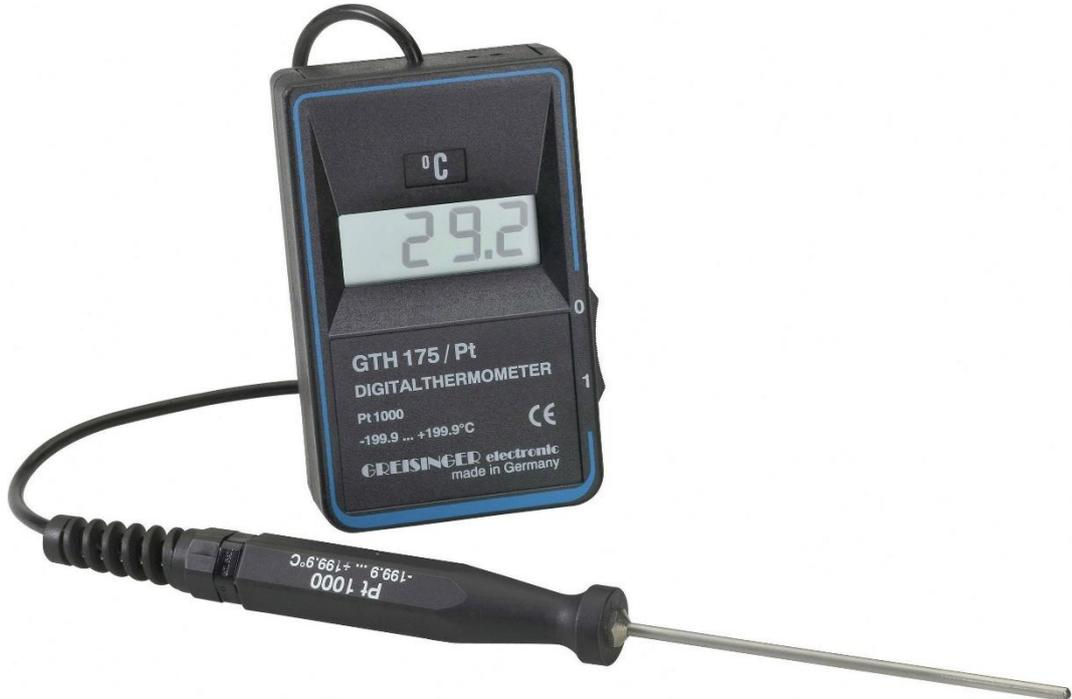
Das Digitalthermometer hat eine Auflösung von 0,1°C. Der Messbereich reicht von ca. -200°C bis +200°C. Es kann zur Messung von Luft-, Oberflächen- und Wassertemperaturen verwendet werden.
